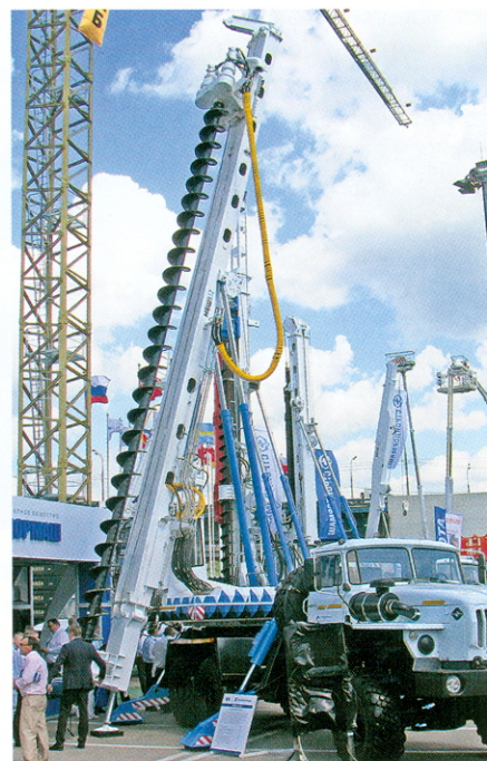
Рис. 15. Машина шнекового бурения ОАО «Стройдормаш» МБШ-812 на базе УРАЛ-4320 на выставке строительной техники и технологий СТТ-2013 в Москве (3–5.06.2013) с самым мощным вращателем, с непрерывным шнеком и возможностью точного позиционирования бурового инструмента и возможным применением технологии полого шнека
