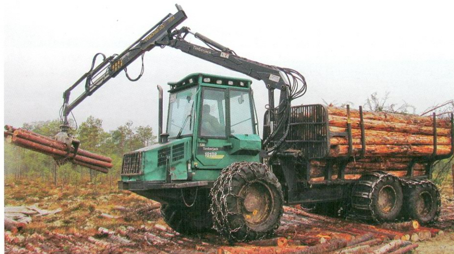
Рис. 4. Использование многофункциональной лесной техники для рубки и уборки просеки от лесных остатков и устройства лежневок (харвейстеры, форвардеры, мульчеры): форвардер «Timberjack (JohnDeer)» 1010C с шарнирно-сочлененной рамой на устройстве лежневки для подъезда к пикету опоры на ВЛ 330 кВ
