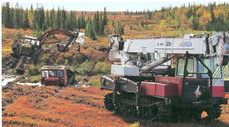
Рис. 3. Тракторная атака: тяжелая переброска отечественной техники в условиях почти непроходимой приполярной трассы ВЛ
