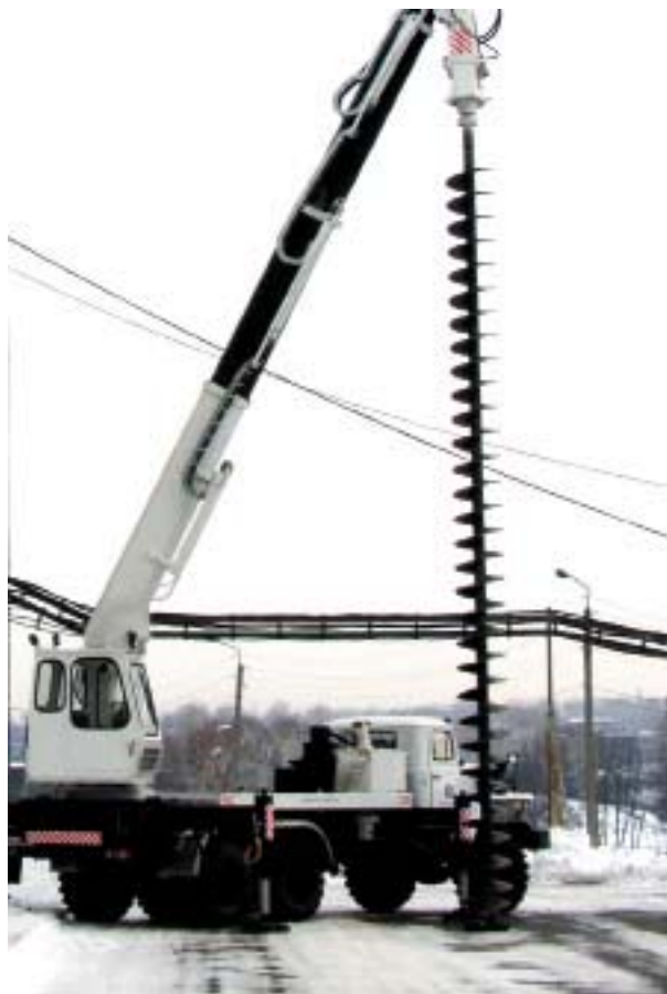
Рис. 12. Универсальная бурильная машина УБМ-85-11, адаптированная для работы в условиях Крайнего Севера с двумя кабинами и дистанционным электрическим управлением (автономный переносный пульт с управлением по радиоканалу либо электрокабелю)
