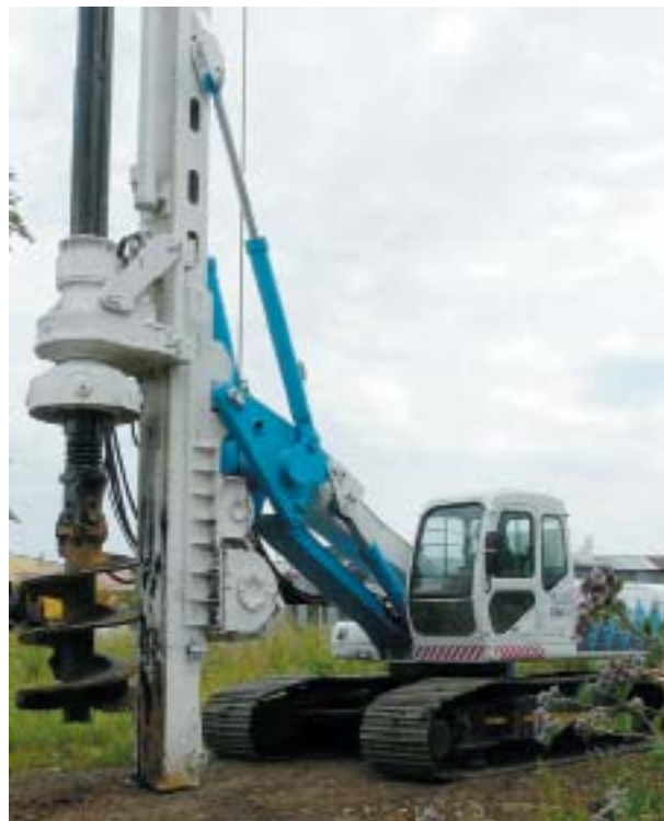
Рис. 9. Строительная буровая установка СБМ-120, обеспечивающая мощное бурение на глубину до 40 м диаметром 1,0 м в режиме с обсадными трубами и 1,5 м — без обсадных труб спецбурами B-bauer01 диаметрами 520, 650, 900, 1060 мм, также разработанными в ОАО «Стройдормаш» для грунтов III-IX категории буримости (СНиП IV-2-82), включая мерзлые и особо тяжелые грунты
